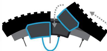
När du kört varvet runt, dra i änden och fäst karborreändarna på den andra halvan av clickfästet. Nu är reTyre Traction monterat och det bör vara en glipa på 0-20mm i skarven.
