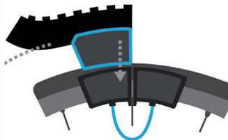
Fäst ena änden på clickfästets ena halva och rulla på reTyre Traction. Se till att reTyre Traction sluter om däck.
