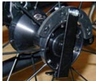
Bild 1. Låst läge - nu kan hjulet plockas bort. Låsplåten ligger runt en eker.
