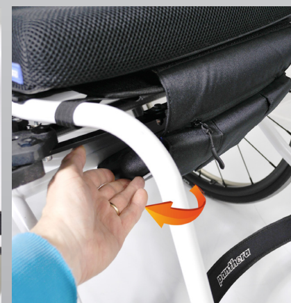
Använd sitsväskans inbyggda magneter för att fästa den mot ramrören vid körning.
