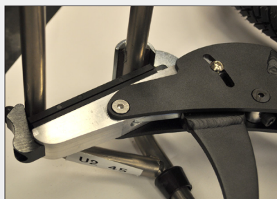
Anpassa hur lång in "slutdelen" ska skruvas in så att FreeWheel passar på fotbågen. Se sid 6.
